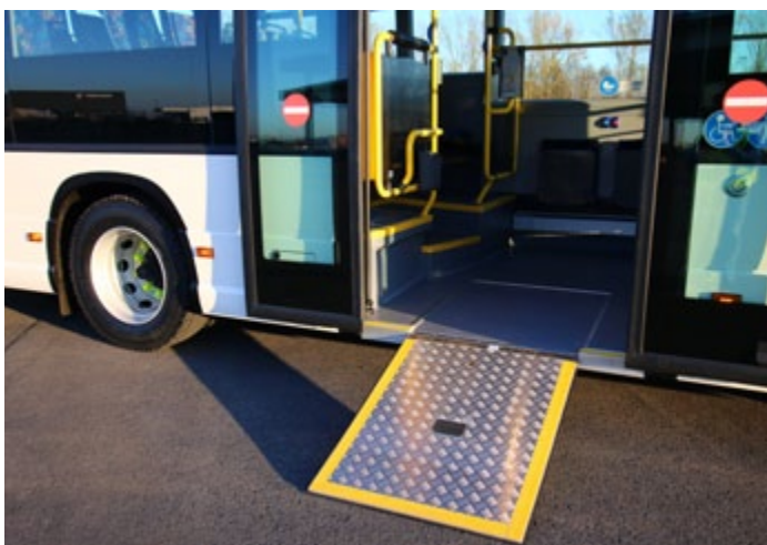
Linienbusse mit Rollstuhlrampe und zusätzlicher Fläche für einen weiteren Rollstuhl.
