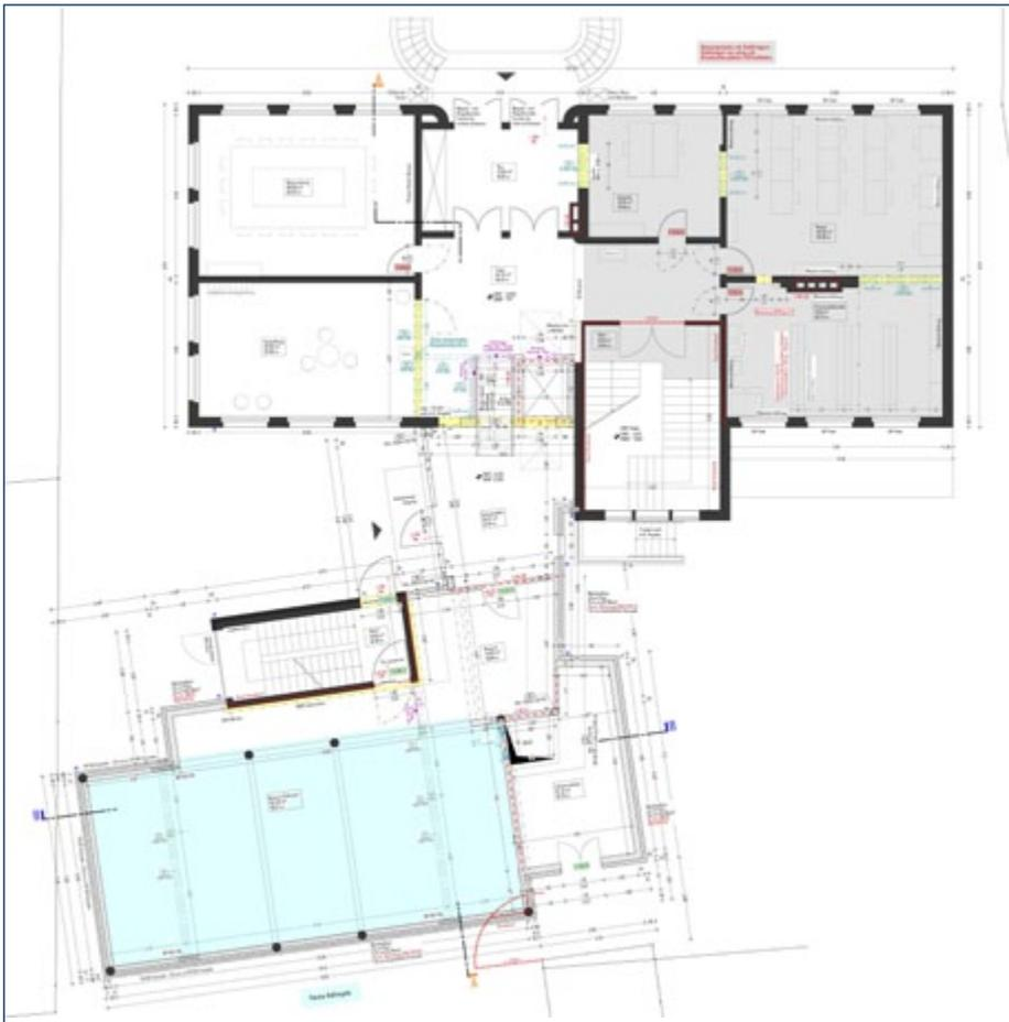
Das klassische Schulgebäude, hier das Erdgeschoss, im oberen Bildteil beherbergt die öffentlichen Bereiche, die Technik- und Besprechungsräume sowie die Werkstätten und die Büros. Im Anbau ist das Magazin untergebracht, beides ist durch einen Gebäudekörper miteinander verbunden.
