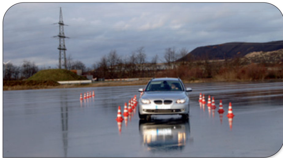
Mit einem schnellen BMW unterwegs auf rutschiger Bahn: Wichtig ist, dass unter immer genau gleichen Bedingungen Tests durchgeführt werden können.
